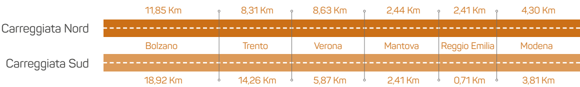
COPERTURA EFFETTIVA DEL TRACCIATO CON BARRIERE ANTIRUMORE AL 31.12.2016
