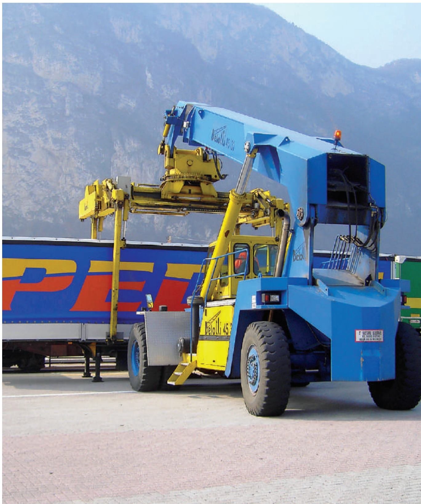
IL CARICAMENTO DI UN SEMIRIMORCHIO SUL TRENO CON UNA GRU INTERMODALE PRESSO L'INTERPORTO DI TRENTO
