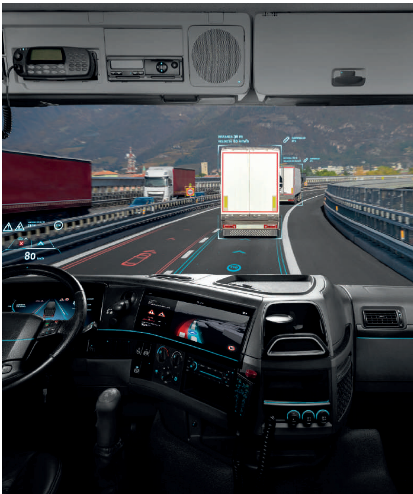
VISUALIZZAZIONE GRAFICA DEL TRUCK PLATOONING SPERIMENTATO LUNGO L'A22: I MEZZI PESANTI SONO CONNESSI TRA DI LORO DA UN SISTEMA WIRELESS PER UNA GUIDA SEMI-AUTONOMA
